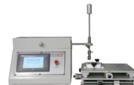
Linear Abrasion Tester
